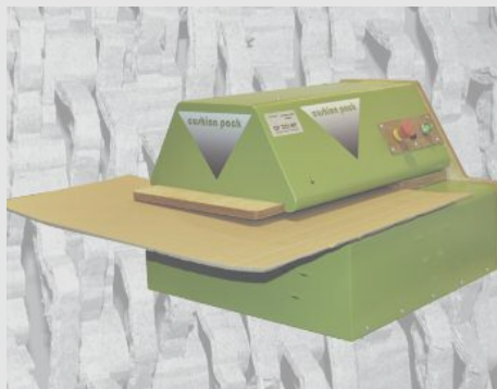
Verpackungspolstermaschine für eine Stundenleistung von 1 m 3 Material
